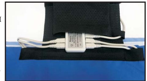
Рис. 15. Присоединение шнуров к модулю-разветвителю. Вы можете довести длительность
